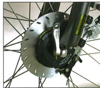
Erstklassige Verzögerung, nahezu wartungsfrei: Shimano Rollenbremse
