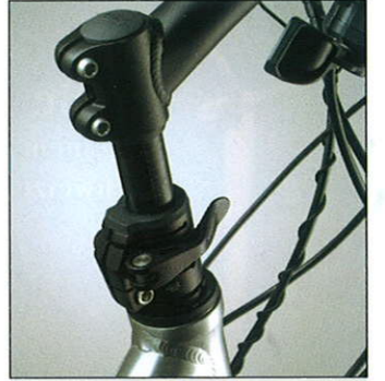
Variabel: Dank „Speedlifter“ ist der Vorbau werkzeuglos höhenverstellbar.
